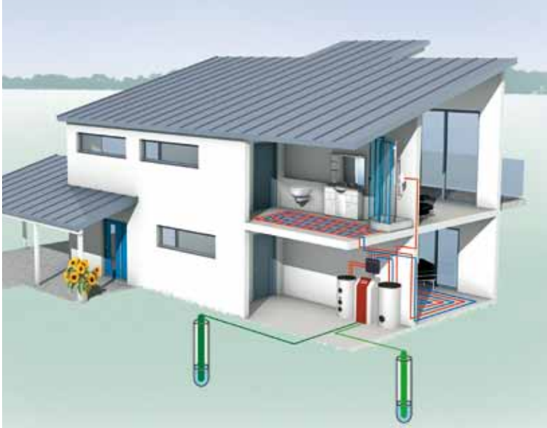
Water/water-warmtepomp met broninstallatie
