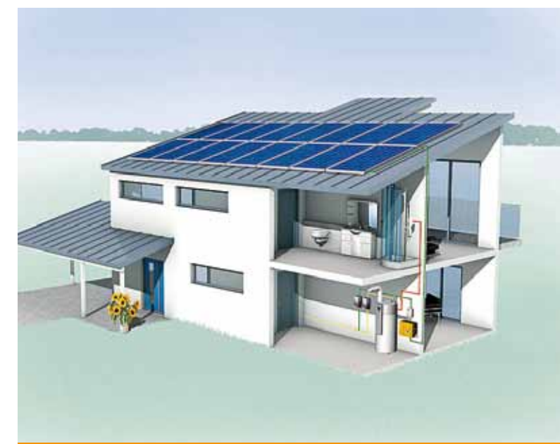
Fotovoltaïsche installatie in verbinding met de warmwater-warmtepomp BWP 30HSD
