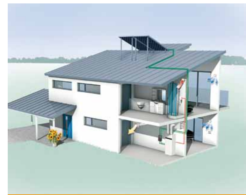
Zonne-energiecollectoren in combinatie met compact huisventilatie-toestel LWP 300W met geïntegreerde warmwaterbereiding
