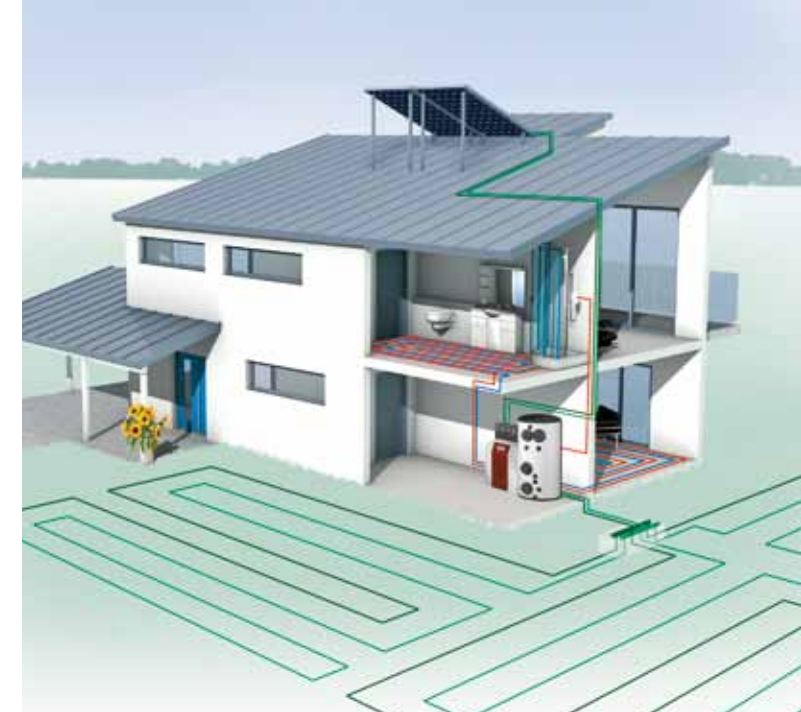
Bodem/water-warmtepompen met grondcollectoren en zonne-energie installatie
